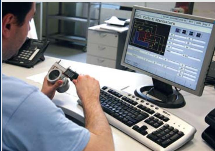
La CNC STATION è un valido supporto per la realizzazione dei programmi. Tutte le funzioni del CNC sono inserite nella CNC STATION; è possibile programmare usufruendo degli stessi strumenti che sono presenti nel CNC quali: cicli predefiniti, linguaggio ISO e con ausilio del VIS-CAD ( semplice CAD-CAM 2D). Inoltre i programmi possono essere archiviati sull'hard disk, trasmessi tramite rete ETHERNET, o salvati ed importati su pen drive.
